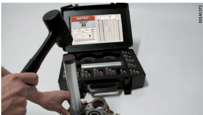
Obrázek 3 Montáž ložiska pomocí kladiva a sady rázových hlavic
