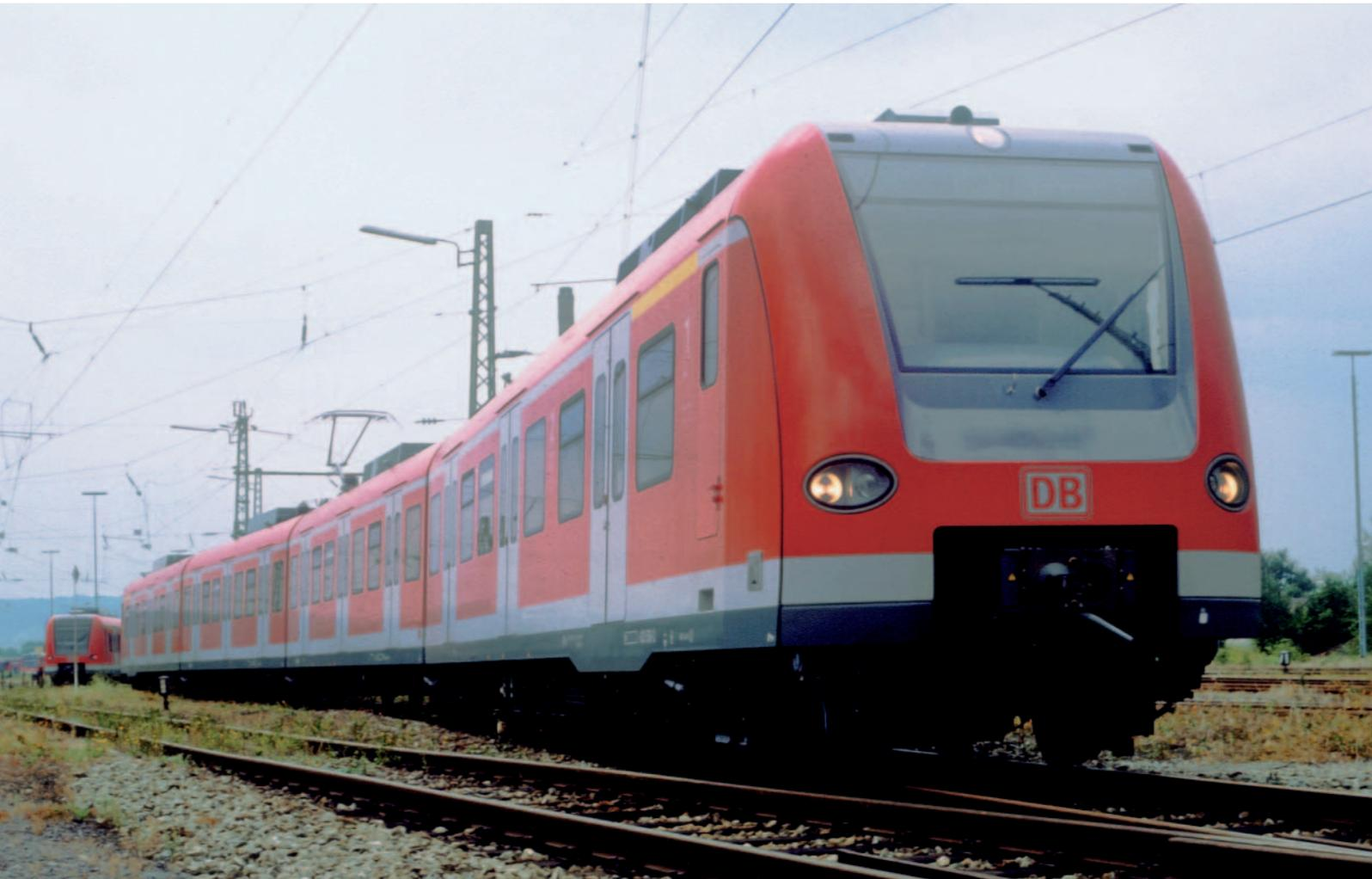
S-Bahn-Triebzug, Baureihe 423: Entwicklung eines Konsortiums aus Bombardier Transportation und Alstom LHB in Zusammenarbeit mit der DB AG
