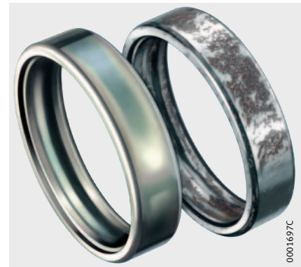
Bild 4 · Mit und ohne Beschichtung im Salzprühtest
