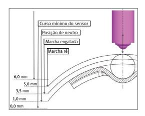
A figura ao lado mostra o percurso total de um sensor e as posições estabelecidas no engate das marchas. É possível ver o deslocamento de 6,0 mm, o que significa o movimento simultâneo do magneto inserido no sensor, usado para emissão dos sinais.
