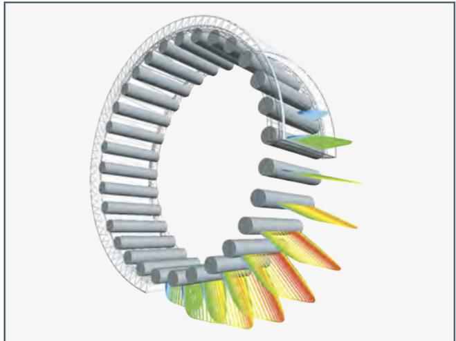
Eine übersichtliche Ergebnisdokumentation sowie die grafische Darstellung der Wellenreaktionen und der inneren Lastverteilung der Lager erleichtern die Analyse der Konstruktionsvarianten. Mit dem Online-Tutorial und einem ausführlichen Hilfesystem lässt sich bequem das ganze Potenzial von → Bearinx ausnutzen.
