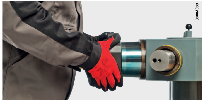
Bild 5 Touchieren mit einem Kegellehrring
