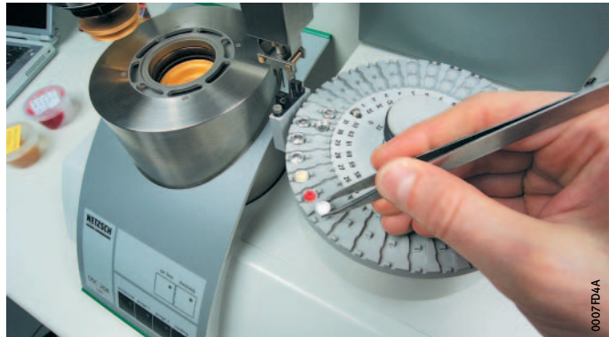
Bild 5 Analyse zum Temperaturverhalten von Fetten
