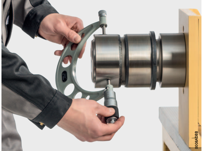
Bild 3 Aufweitung mit Außenmikrometer messen
