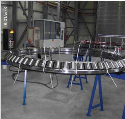
Anwärmen eines Kegelrollenlagers
