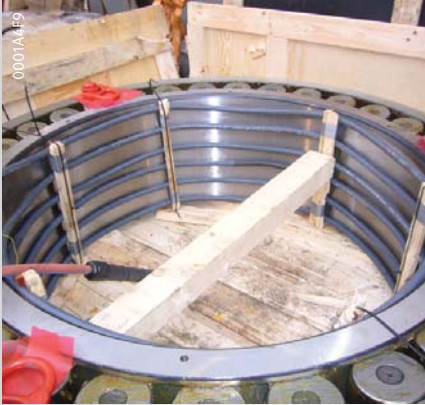
Anwärmen eines Pendelrollenlagers
