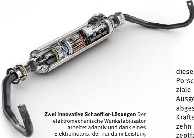
**Zwei innovative Schaeffler-Lösungen** Der elektromechanische Wankstabilisator arbeitet adaptiv und dank eines Elektromotors, der nur dann Leistung aufnimmt, wenn sich der Schwenkaktor verdreht, sehr effizient. Das weltweit erste vollvariable elektrohydraulische Ventilsteuerungs-System UniAir (links) ist ein wichtiger Schlüssel, um die Effizienz von Verbrennungsmotoren zu steigern
