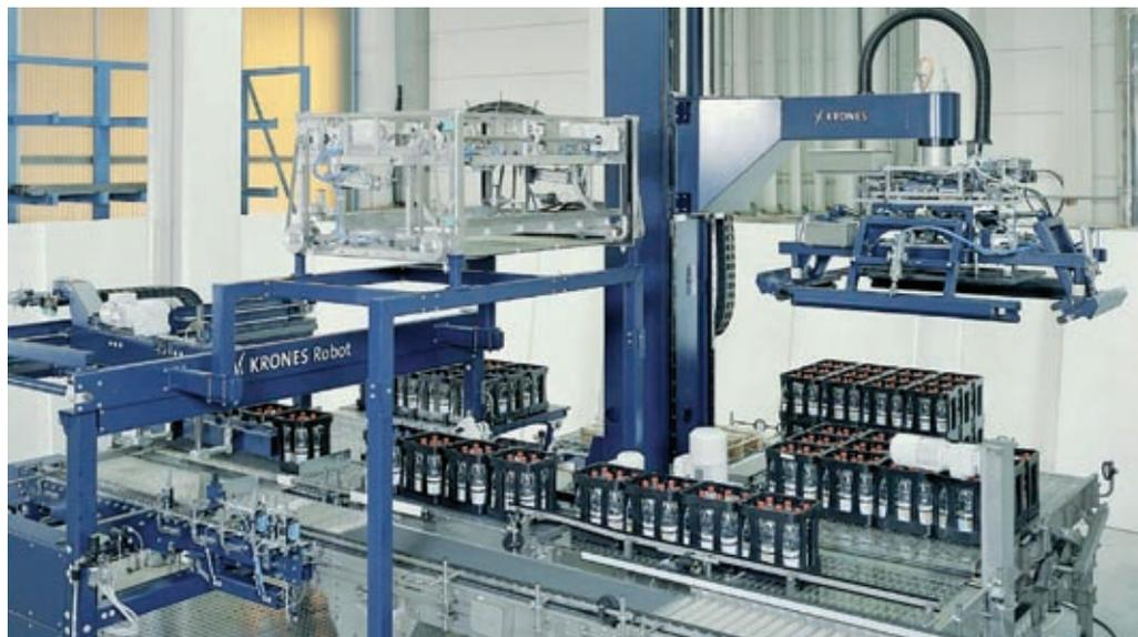
Unità a ricircolazione di rulli INA in un robot per imballaggio e pallettizzazione: In questo modo il costruttore può garantire la precisione dei propri impianti anche con carichi importanti e una lunga sicurezza di processo (immagine: KRONES)
