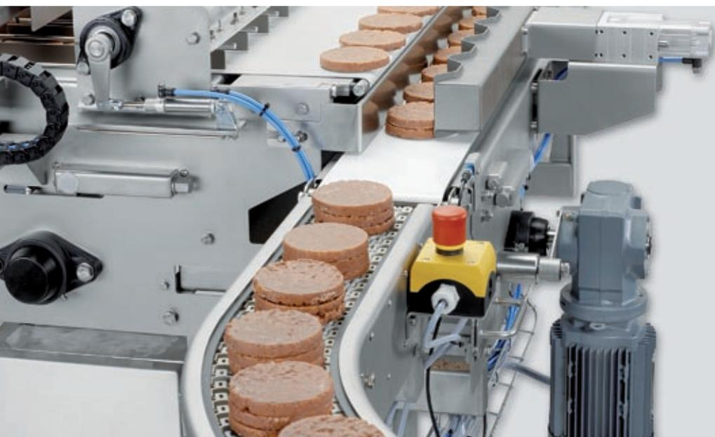
Per alimenti e con protezione anticorrosione: alloggiamento flangiato in plastica per sistema di trasporto cialde (Immagine: TMF Belting Systems B.V.)
