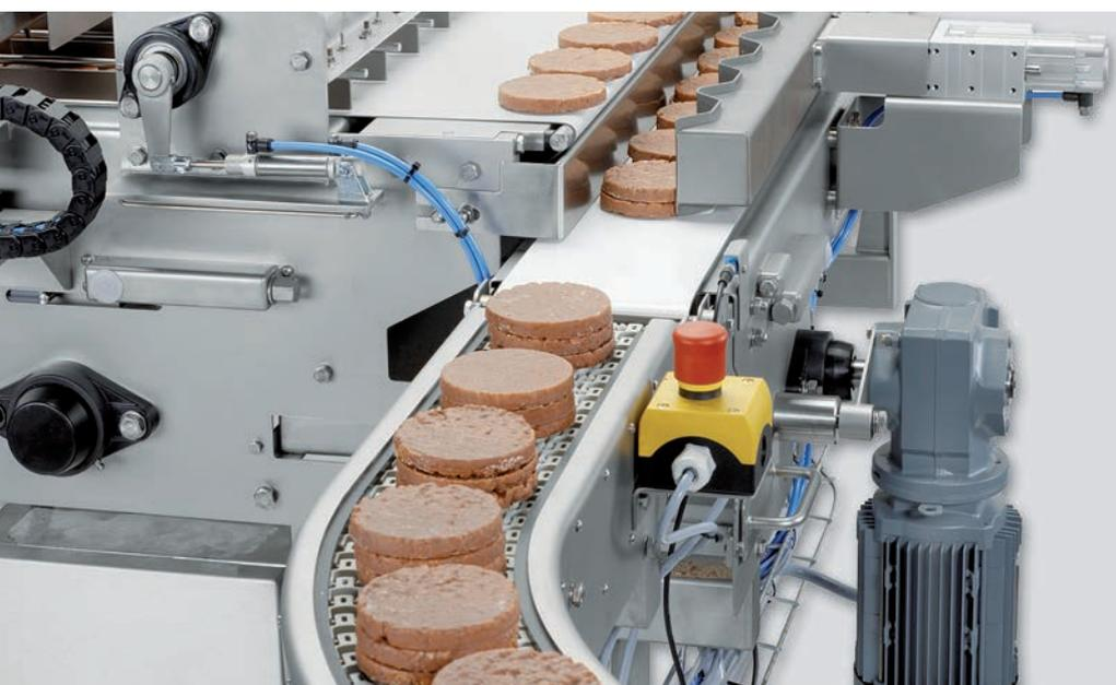
Compatible avec les denrées alimentaires : les roulements auto-aligneurs protégés contre la corrosion avec corps de palier applique en matière plastique montés dans un convoyeur (photo : TMF Belting Systems B.V.)
