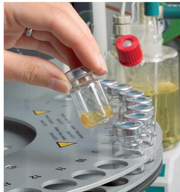
Contrôle en laboratoire : vérification de la teneur en eau des lubrifiants
