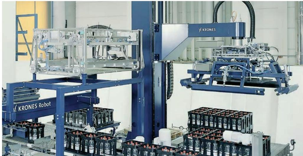
Systèmes à recirculation de rouleaux INA sur un robot de manipulation et de palettisation : le constructeur de machines garantit ainsi à long terme la précision et la sécurité des procédés de son installation même exposée à de fortes charges (photo : KRONES)
