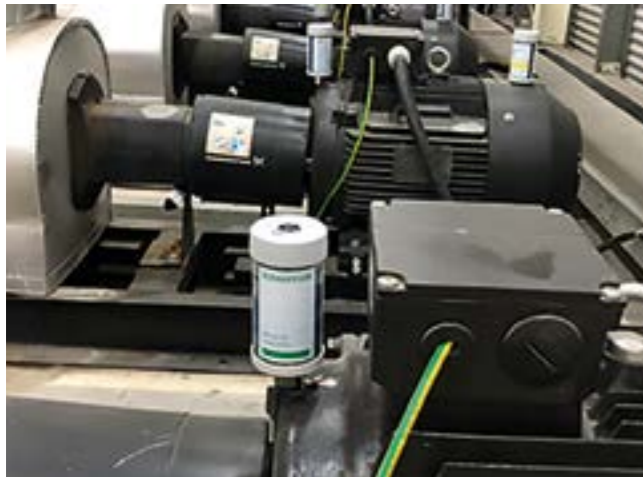
Solución de lubricación Industria: CONCEPT1 lubrica numerosos motores
