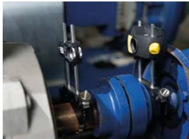
Herramientas industriales – Alineación Industria: LASER-EQUILIGN2 garantiza siempre una alineación profesional de sus máquinas gracias a la tecnología de láser único.
