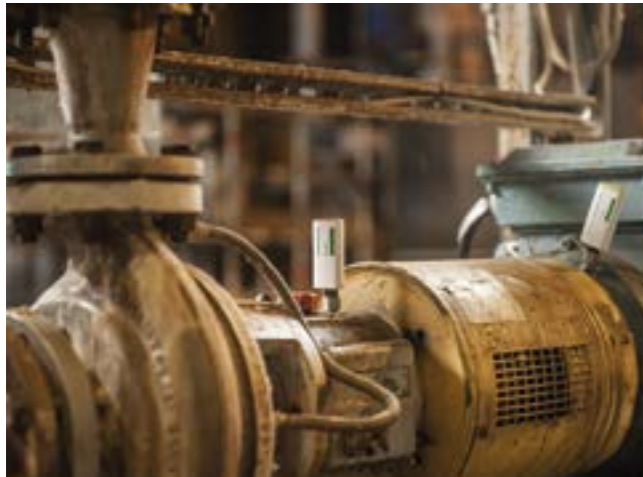
Solución de Condition Monitoring Planta de papel: OPTIME da buenos resultados en la monitorización de motores
