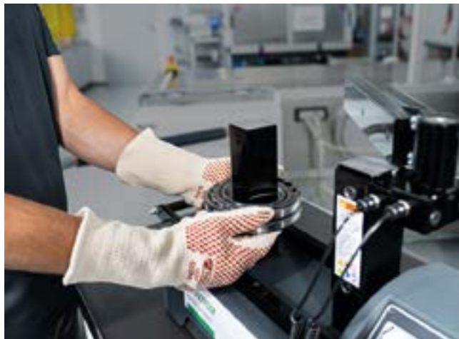
Herramientas industriales – Montaje Industria: Gracias al calentamiento por inducción, los HEATER previenen daños como el funcionamiento irregular, las roturas o las marcas de abrasión.
