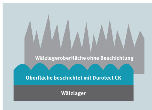
Strukturfrage: Mit Durotect CK beschichtete Oberflächen sind verschleißfester und wirken reibungssenkend
