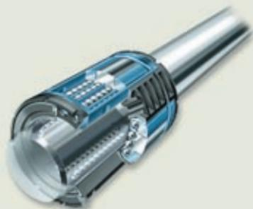
Elevata capacità di carico: cuscinetti a sfere per movimenti lineari della serie pesante – buona compensazione degli errori di allineamento con quattro segmenti autoallineanti – taglia da 12 a 50
