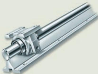
Ottimo funzionamento: guida per alberi molto rigida con cuscinetti massicci a sfere per movimenti lineari sulla guida portante – anello esterno temprato e con rettifica di precisione
