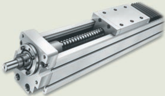
Stor nøjagtighed: Linearmodul med profilskinneføring og indbygget spindeldrev – spindlen skjules af en bælge – præcis føring af mellemstore til store belastninger
