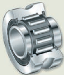
Profilløberulle (frileje): Nålelejer med en profileret yderring og en forskydelig inderring – kan kombineres med bæreskiner
