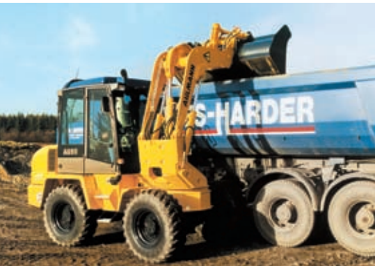
Radlader im Einsatz – hohe Belastung für die Lagerstellen (Foto: Ahlmann)
