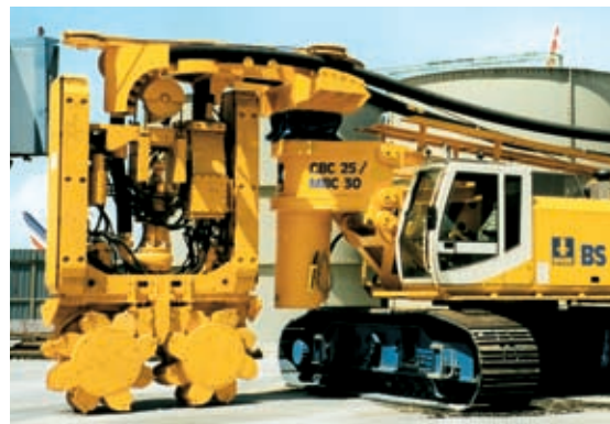
Eine robuste Lösung: Lagerung des Schlauch-Aufrollers mit INA-Vierpunktlager (Foto: Bauer AG)
