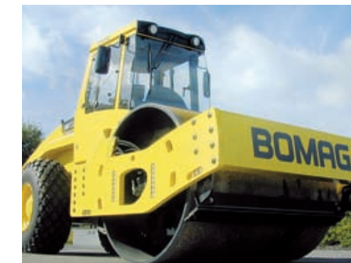
Walzenzug mit Vierpunktlager und wartungsfreien ELGES-Gelenklagern in Knick-Pendelgelenken (Foto: BOMAG)
