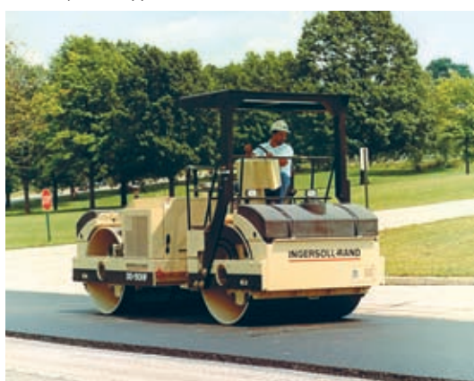
Die Unwuchtwellen in Straßenwalzen können mit den neuen INA/FAG-Zylinderrollenlagern sicher geführt werden (Foto: Ingersoll-Rand)
