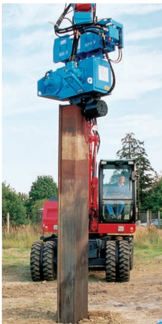
Dynamik gefragt: Zylinderrollenlager LSL vertragen hohe Beschleunigungen – wichtig z. B. in Aufsatzrüttlern (Foto: ThyssenKrupp)
