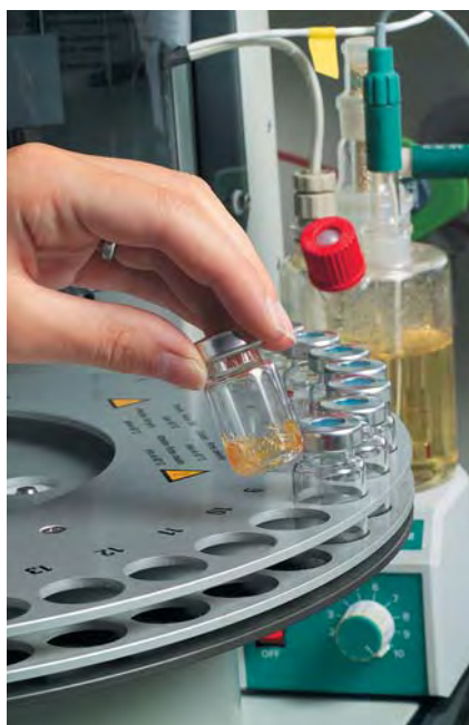
私共の社内の研究所における試験：水分に関する潤滑油の分析
