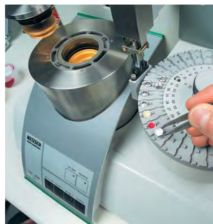
DSC 分析：最新の手法を用いて分析される潤滑剤の温度挙動
