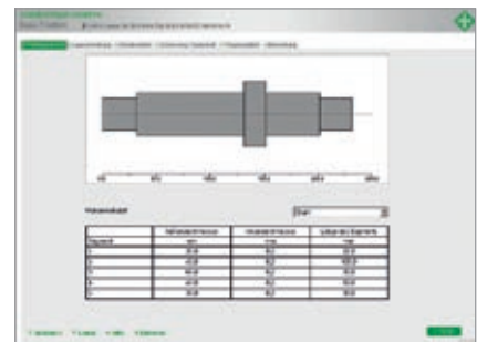
① Modellierung der Wellengeometrie
