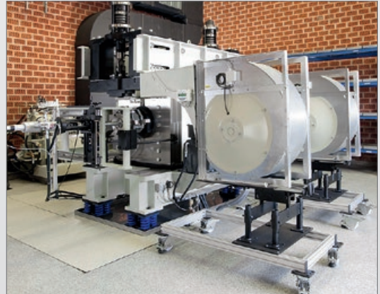
Bahnanwendungen – Radsatzlager Prüfung des Leistungsvermögens EN12082
