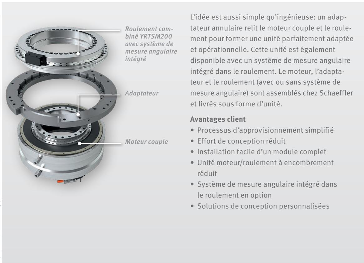
L'idée est aussi simple qu'ingénieuse: un adaptateur annulaire relie le moteur couple et le roulement pour former une unité parfaitement adaptée et opérationnelle. Cette unité est également disponible avec un système de mesure angulaire intégré dans le roulement. Le moteur, l'adaptateur et le roulement (avec ou sans système de mesure angulaire) sont assemblés chez Schaeffler et livrés sous forme d'unité.
