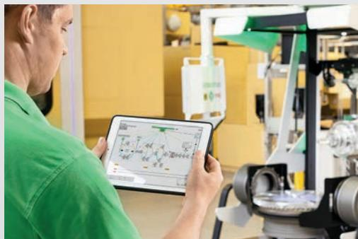
L'accent est mis sur deux services digitaux : le calcul de la durée d'utilisation résiduelle de roulements et le diagnostic automatisé des roulements. Pour la première fois, il devient possible de déterminer la fréquence des entretiens en fonction de la charge exercée sur les roulements.
