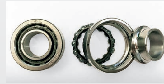
Cermadur-Lager aus Seil-Umlenkrolle nach 37 Wochen Testbetrieb. Auf der Ringoberfläche hat sich ein dünner Schmutzbelag abgeschieden. Die Laufbahn ist abgesehen von Salzablagerungen blank. Das Lager ist uneingeschränkt funktionstüchtig.
