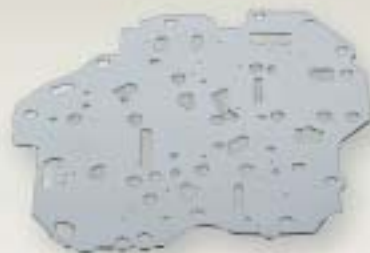
Tôle intermédiaire (Ø 210 mm) Pour système hydraulique de boîtes de vitesses – comporte 77 perçages, dont certains d'un diamètre de 0,8 mm pour une épaisseur de matériau de 1,2 mm.
