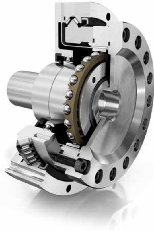
Mit den besonders steifen Schrägnadellagern XZU sowie konstruktiv und fertigungstechnisch optimierten Flexsplines entwickelte Schaeffler neue Wellgetriebe, die über außergewöhnlich hohe Präzision, Drehmomentdichte und Lebensdauer verfügen. Eine optimierte 3D-Zahngeometrie der Flexsplines macht eine gleichmäßigere Lastverteilung auf die Verzahnung und einen vollständigen Zahn-eingriff möglich. Die Präzisionsverzahnung wird außerdem spanlos durch Umformung hergestellt. Diese bietet signifikante
