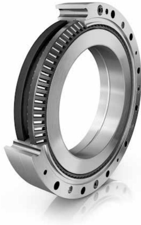
Speziell für Gelenkarme von Leichtbaurobotern und Cobots entwickelte Schaeffler eine neue Lagerbauart: die zweireihigen Schrägnadellager der Baureihe XZU. Sie wurden auf höchste Kippsteifigkeit und einen reduzierten, gleichmäßigen Reibwiderstand hin optimiert. Eine der Besonderheiten: Die Schrägnadellager verfügen über den gleichen Querschnitt wie die häufig eingesetzten Kreuzrollenlager und sind mit
