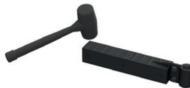
4. Drücken Sie auf Start, um das Anwärmgerät einzuschalten. Das Joch setzt sich nun selbst fest. Gegebenenfalls kann außerdem ein rückschlagfreier (Kunststoff-) Hammer verwendet werden.
