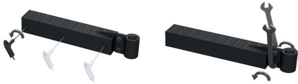
3. Lösen Sie die Inbusschrauben und die Bolzen an der Scharnierbuchse um ca. eine halbe Drehung.
