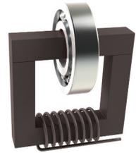
Die Primärwicklung wird über eine elektronische Steuerung mit dem Stromnetz verbunden. Das Magnetfeld induziert einen hohen Strom (Kurzschlussstrom) durch das Lager, der das Lager erhitzt. Nach jedem Anwärmerzyklus werden Lager beziehungsweise Werkstücke automatisch entmagnetisiert.
