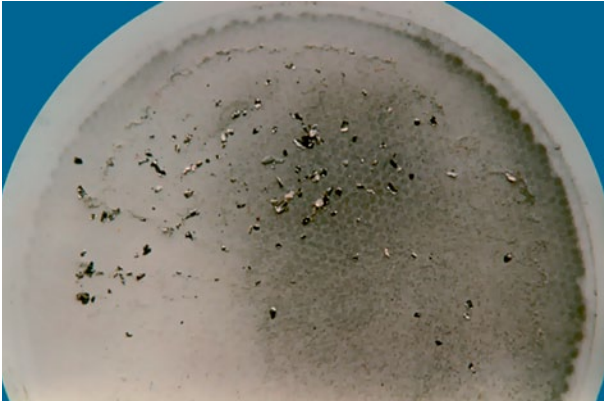
Resíduos de alumínio resultantes da usinagem do cabeçote
