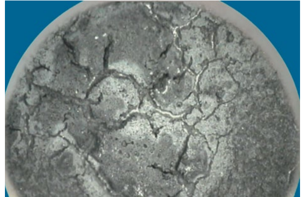
Depósitos de combustão em motores diesel
