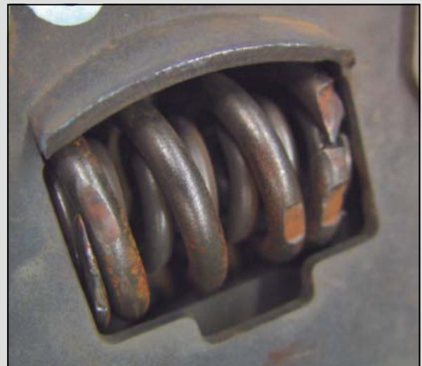
Verschleiß und Risse am Torsionsdämpfer
