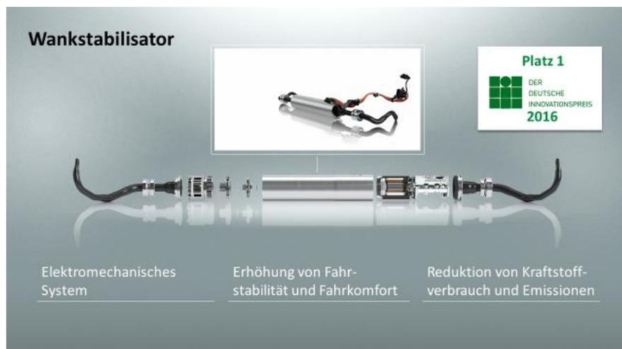
Ein **Wankstabilisator** gleicht – wie der Name sagt – die Wankbewegung eines Fahrzeugs bei einer Kurvenfahrt aus. Das bedeutet mehr Fahrkomfort. Und zugleich mehr Energieeffizienz. Der Wankstabilisator besteht im Wesentlichen aus drei
