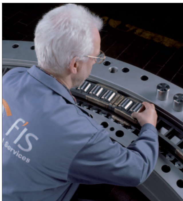
2: Kunnostetun tunneliporakonelaakerin asennus
