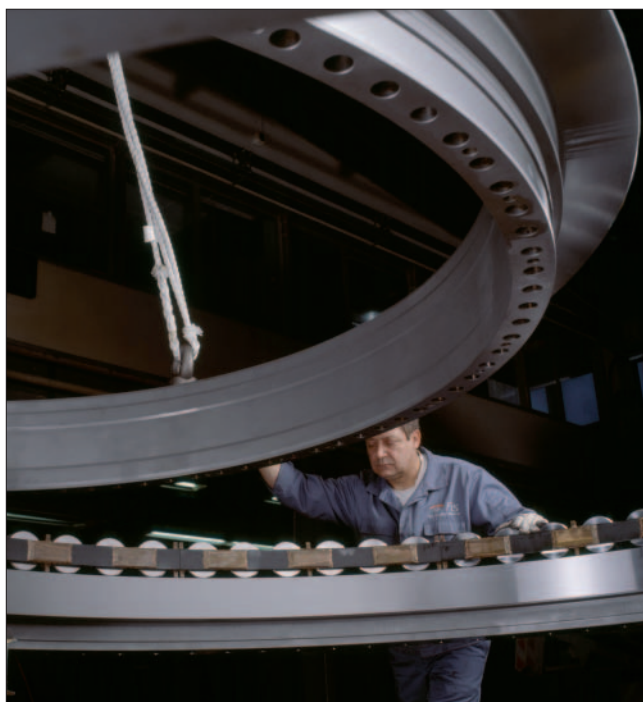
1: Kunnostetun tunneliporakonelaakerin asennus
