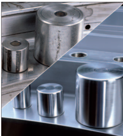
6: Ennen: rullissa on syöpymisjälkiä ja epäpuhtauksien aiheuttamia painautumia Jälkeen: uudet rullat tarkasti sovitetun ylikokoisina
