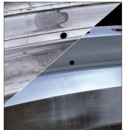
8: Ennen: vierintäradassa voimakkaita naarmuja liukumakohdissa Jälkeen: jälkihiottu vierintärata
