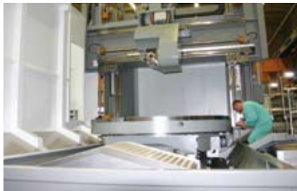
大型万能铣床DMU 340 P，安装INA直线滚子轴承和导轨组件RUE65-E（X轴）和RUE55-E的主工作轴X、Y和Z
