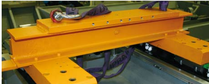
在DECKEL MAHO Pfronten的测试滑轨，用于检查机器几何形状和调整导轨
