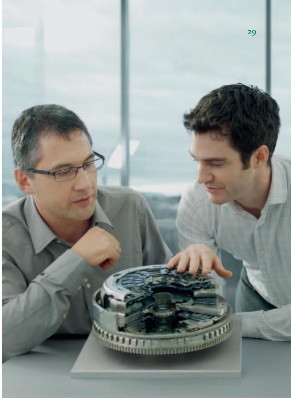
ihre Automobile noch effizienter zu machen: In den ohne Zugkraftunterbrechung arbeitenden, blitzschnell schaltenden Doppelkupplungsgetrieben sind trockene Kupplungsbeläge verbaut. Der Einsatz dieser Getriebe verursacht einen Kraftstoffverbrauchsvorteil von bis zu 10 % im Vergleich zum konventionellen Automatikgetriebe. Bis heute haben wir weit mehr als zwei Millionen dieser Bauteile ausgeliefert.
