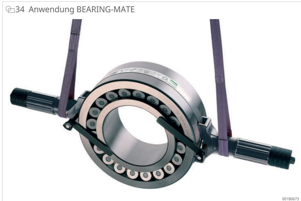
Das Werkzeug mit Lager wird von 2 Personen oder von einem Kran getragen. Bei Verwendung von 2 Trageriemen kann das Wälzlager beim Transport mit dem Kran in jede beliebige Position gedreht werden. Während des Anwärmens auf einem induktiven Anwärmgerät bleibt das Werkzeug auf dem Lager montiert. Die Stahlbänder dehnen sich gleichmäßig mit dem Lager aus. Ihre optimale Spannung bleibt erhalten.
