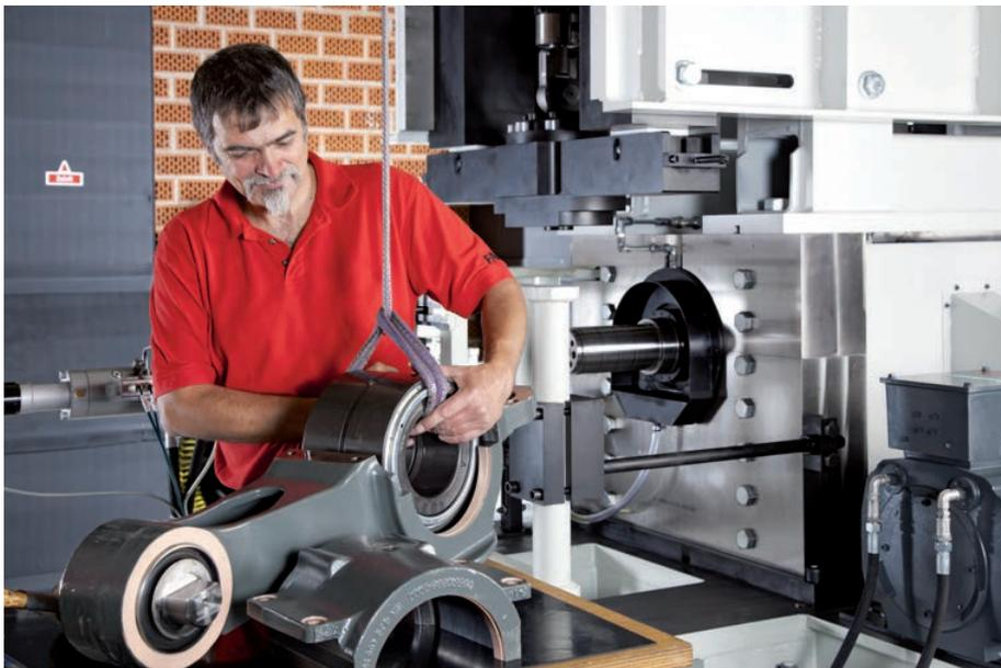
sind Tests mit Geschwindigkeiten bis zu 600 km/h möglich. Ebenso können Radsatzlager geprüft werden, die im Güterverkehr unter hoher Achslast fahren, also mit bis zu 40 Tonnen pro Achse an Frachtvolumen. Als besonderen Service bietet der Schaeffler Industrial Aftermarket (IAM) die qualifizierte und wirtschaftliche Wiederaufbereitung von Bahnlagern.
