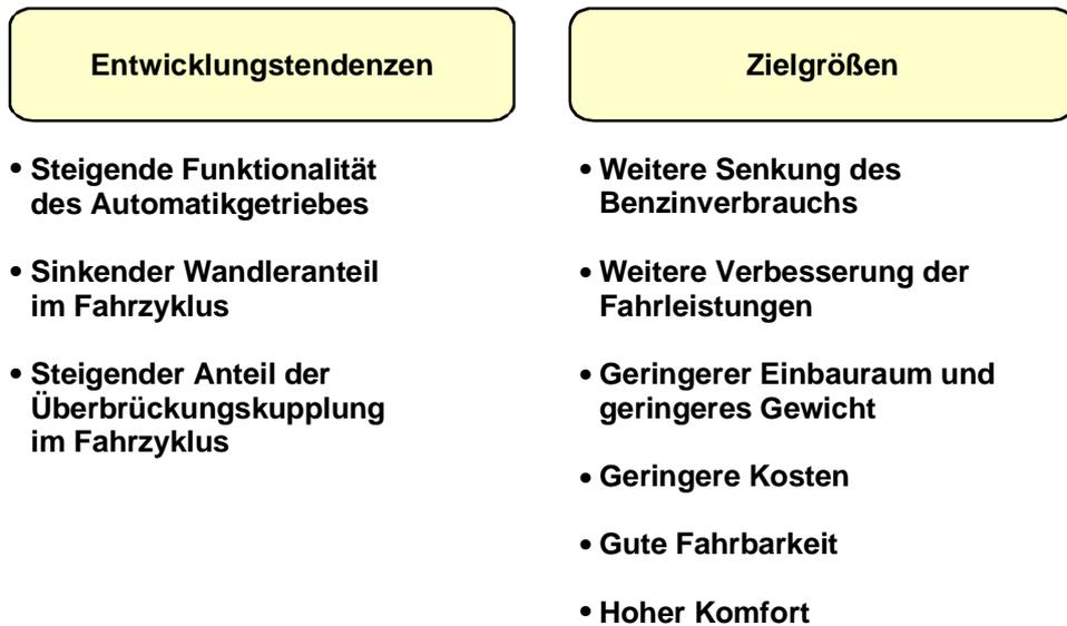
Bild 4: Globale Entwicklungstendenzen und Entwicklungsziele des Systems Wandler und Überbrückungskupplung
