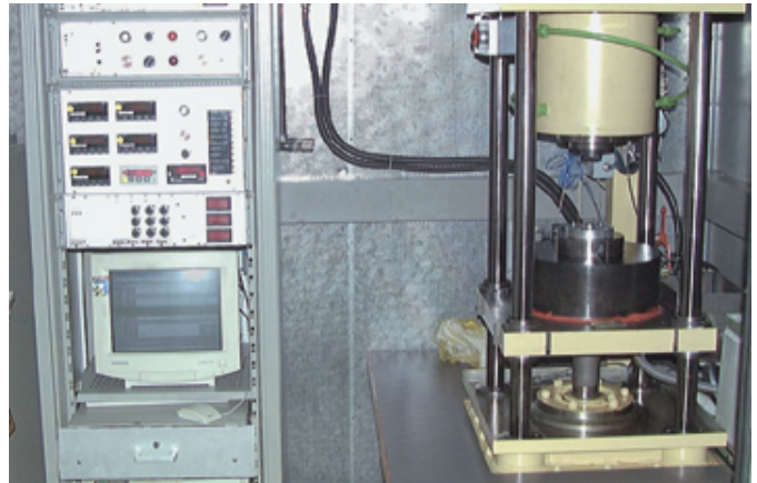
Bild 2 Mit diesem Prüfstand lassen sich Wälzlager bei einer Motordrehzahl von 11 bis 4000 min -1 und einer Belastung bis 100 kN untersuchen
