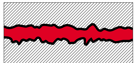
a) Täysvoitelu Kantava öljykalvo erottaa pinnat täydellisesti toisistaan.
