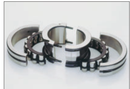
4: Jaettu pallomainen rullalaakeri, jossa on jaettu massiivinen pidin lasikuituvahvisteisesta polyamidista tai messingistä, integroidut kiristysrenkaat
