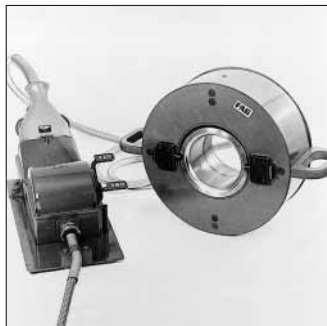
45: Dispositivo inductivo de montaje para 380 V durante el calentamiento de un aro interior.
