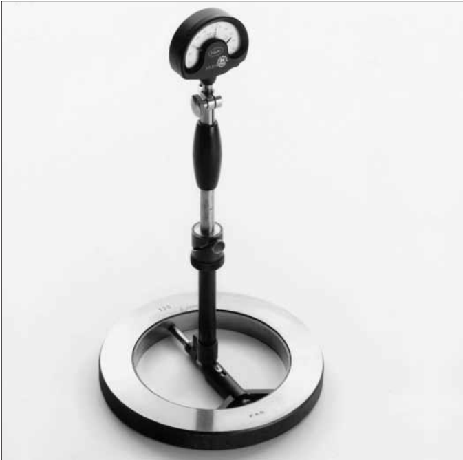
5: Para la medición de agujeros se utilizan sobre todo instrumentos de comparación. El aro-calibre mostrado se utiliza para la regulación.
