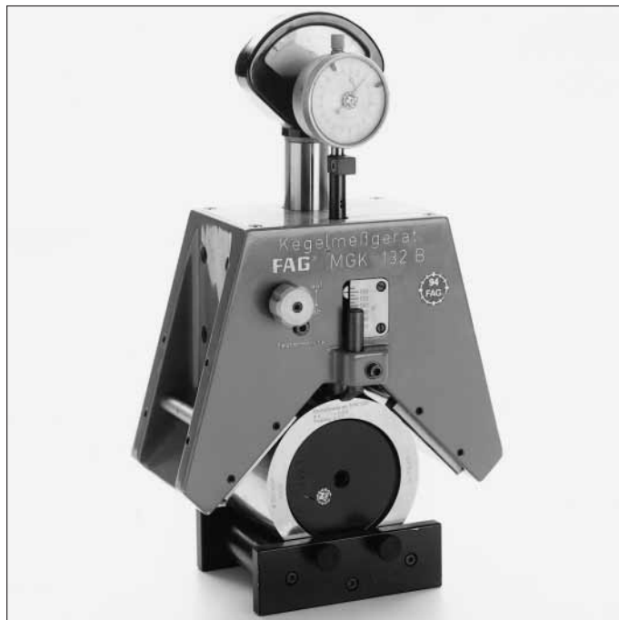
12: Instrumento de calibre cónico FAG MGK 132 vale para longitudes cónicas de 80 mm y diámetros cónicos de 90 a 820 mm.
