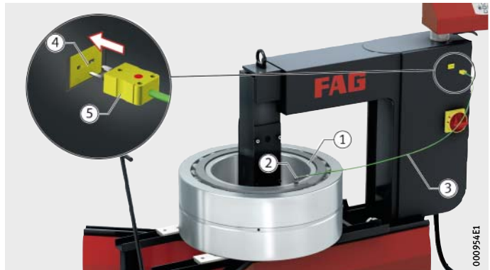
Bild 20 Temperaturfühler anschließen und anbringen
