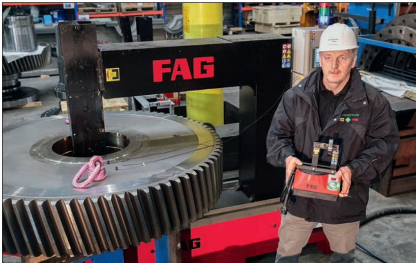
Méreték összehasonlítása: Az eddig a Schaeffler által megépített legnagyobb FAG HEATER5000 a hordozható FAG HEATER10-zel összehasonlítva
