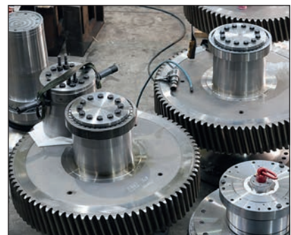
A legnehezebb fogaskerék majdnem 5 tonna súlyú, melynek külső átmérője csaknem 1,700 mm
