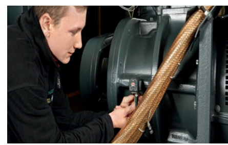
Példa FAG SmartCheck szerelésére
