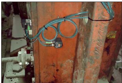
A FAG SmartCheck rendszerek felügyelik a hajtásoldali tengelycsapágy állapotát.
