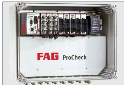
Időközben már a FAG ProCheck felügyeli a csőmalom összes fontos komponensét.
