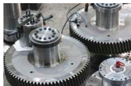
▲ Nejtěžší ozubené kolo váží skoro pět tun a má největší průměr 1 700 mm.
