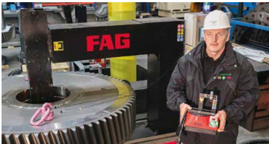
▲ Porovnání velikosti: FAG HEATER5000 – dosud největší ohříváč vyrobený v koncernu Schaeffler ve srovnání s mobilním modelem FAG HEATER10.
