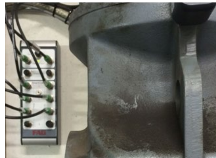
La FAG SmartConnect Box peut fournir le courant et transmettre les informations des FAG SmartCheck
