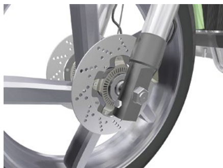
Hohe Energieeffizienz durch robustes Radlager mit Lippendichtungen
