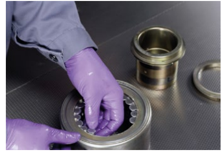
Befetten der Lager
