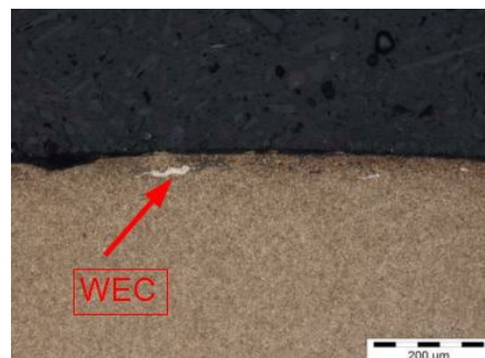
„White Etching Cracks“ (WEC) unter der Laufbahn- oberfläche
