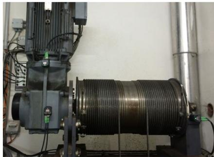
Drei FAG SmartCheck sorgen für eine sichere Alarmierung am Palettenheber
