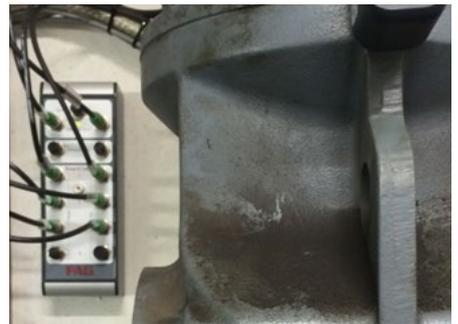
Die FAG SmartConnect Box verteilt Spannung und Zusatzsignale an bis zu vier FAG SmartCheck
