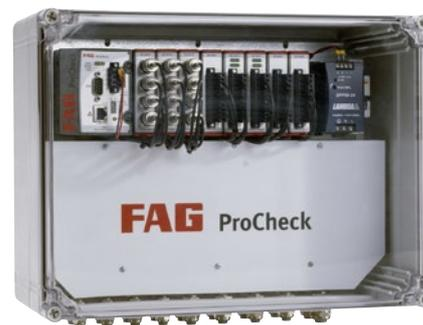
Entretemps le FAG ProCheck contrôle tous les points critiques du broyeur tubulaire
