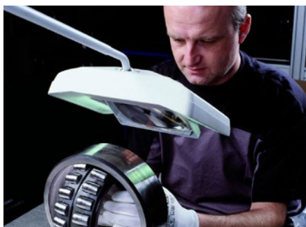
Lager prüfen und begutachten
