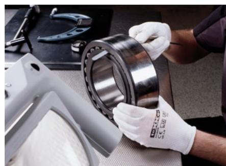
Проверка зазора в подшипнике.
