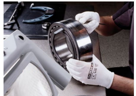
Überprüfung der Lagerluft
